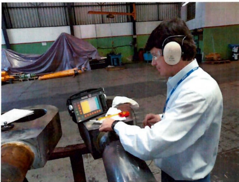
Figura 2.32 – Execução do ensaio por ultrassom convencional Fonte: Arquivo Poliend.
