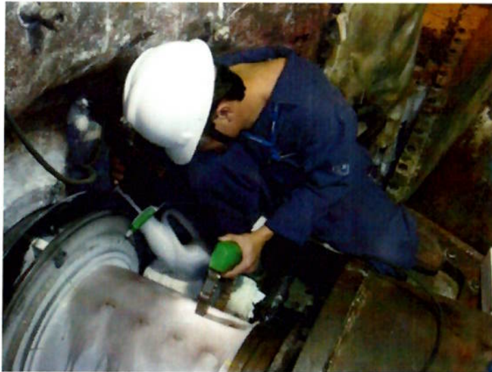
Figura 2.17 – Inspeção por partículas magnéticas por indução de fluxo. Fonte: Poliend
