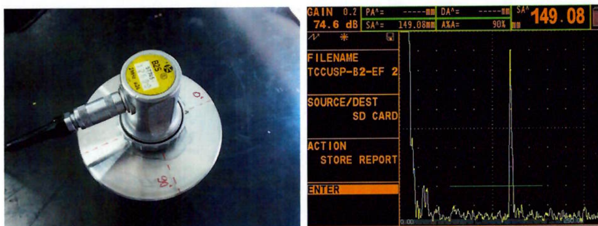
Figura 5.4 – Acoplamento do transdutor B2SN no sentido axial do lingote
