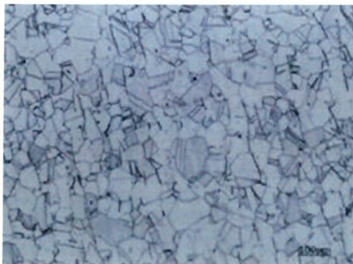
Figura 2.6 – Microestrutura típica do metal base AISI 316L Fonte: Laboratório Unimep
