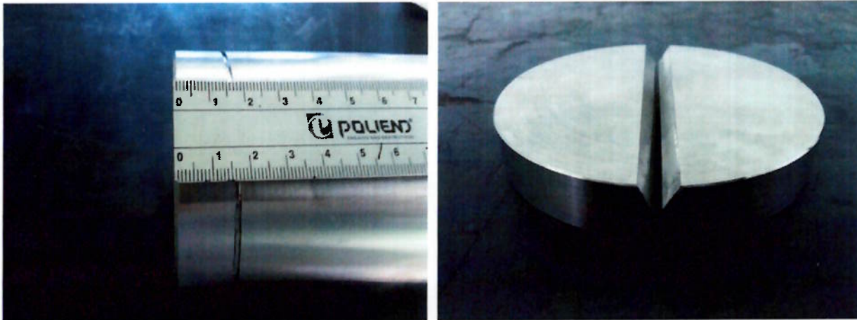
Figura 4.17 – Extração dos discos no corpo do lingote e usinagem dos chanfros para realização da soldagem.
