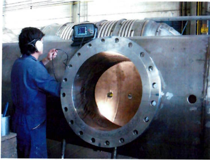
Figura 1.1 – Inspeção de um vaso de pressão em aço inoxidável. Construído na empresa Dedini/Piracicaba (Fonte: Poliend)
