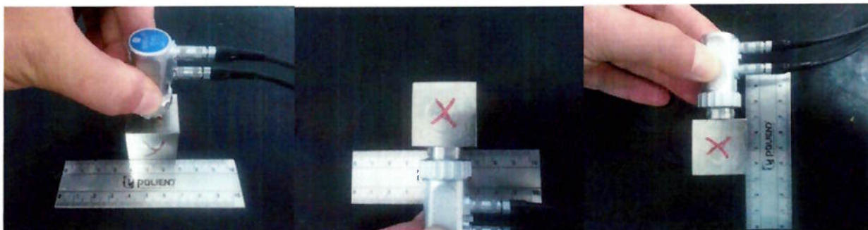
Figura 4.13 – Acoplamento do transdutor MSEB4H nas direções X, Y e Z para análise da atenuação sônica.
