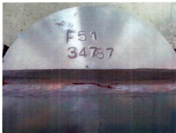
Figura 5.21 – Inserção de trinca longitudinal no cordão de solda do CP-USP-05.
