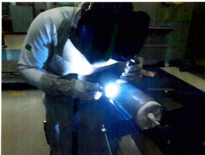
Figura 2.10 – Processo de soldagem TIG. Fonte: Poliend
