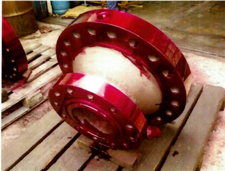
Figura 2.15 – Inspeção por líquido penetrante Fonte: Poliend
