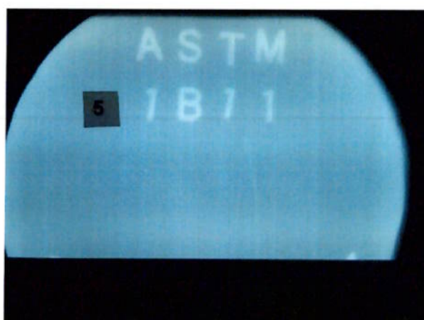
Figura 5.20 – Radiografias da junta CP-USP-05. Imagem isenta de descontinuidade - aprovada
