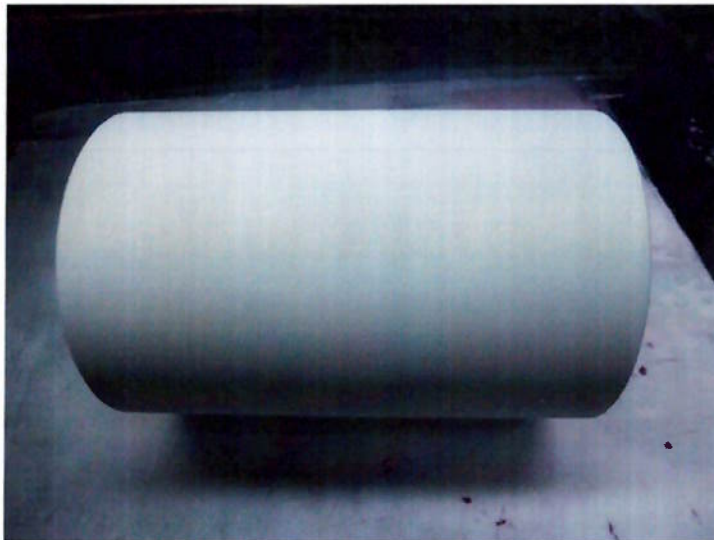
Figura 5.1 – Resultado do ensaio por líquido penetrante no lingote usinado Isento de descontinuidades
