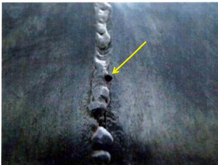
Figura 2.14 – Poro/Porosidade Fonte: Poliend
