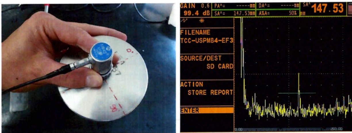
Figura 5.6 – Acoplamento do transdutor B2SN no sentido axial do lingote
