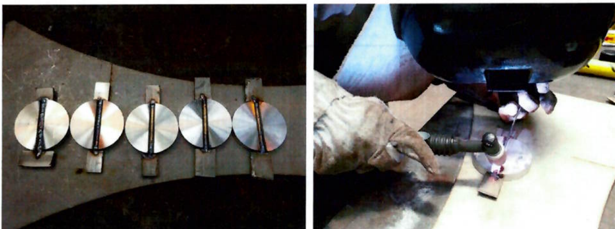
Figura 4.18 – Preparação das juntas e execução da soldagem
